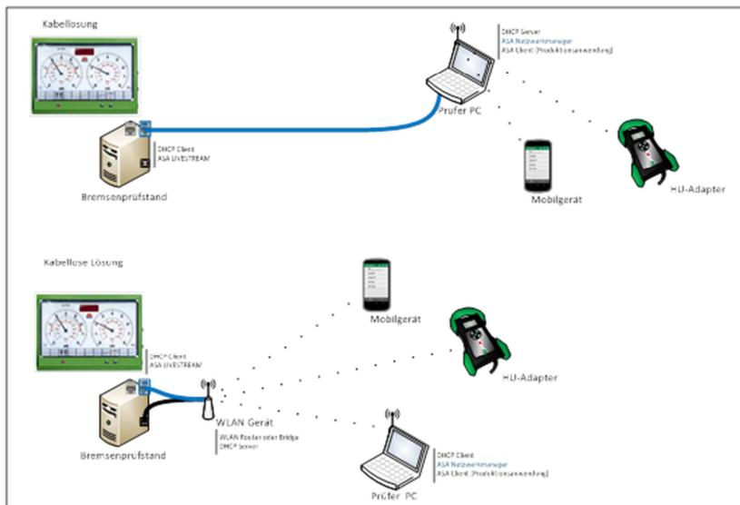
Bild 2: Systemdarstellung der Anbindung mit DHCP Server auf dem Produktivsystem der Überwachungsorganisation oder dem WLAN Gerät nach 3.1b
